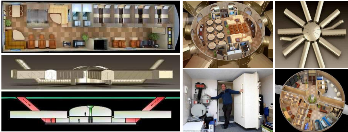
شكل (١١) يوضح مساقط أفقية وقطاعات وعناصر مأوى فاخر غير قابل للتدمير ضد الأسلحة النووية في ولاية كانساس، أمريكا [٣٣].
