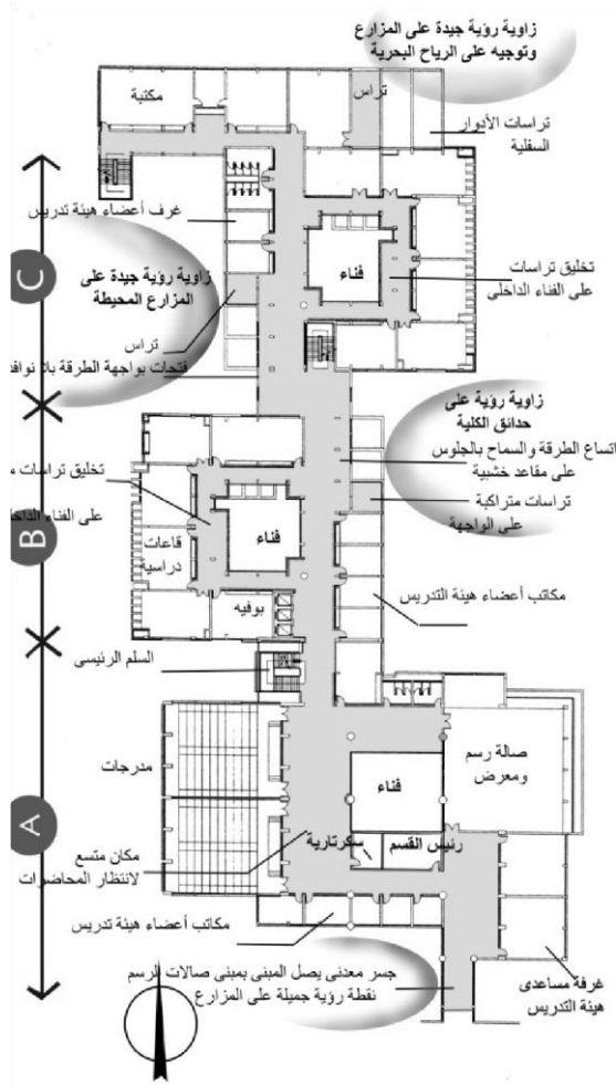
شكل (٤) المسقط الأفقي للدور الرابع يوضح الفكرة التصميمية للمبنى
