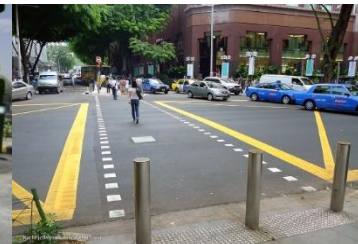
شكل (١٨) وضع الحواجز عند أماكن مرور المشاة مع إمكانية دمج الإضاءة مع الحواجز لتحسين الرؤية المصدر: (Rémillard-Boilard, Buffel, & Phillipson, 2020)
