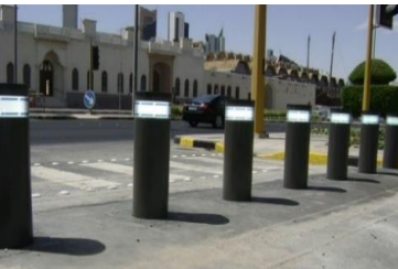
شكل (١٨) وضع الحواجز عند أماكن مرور المشاة مع إمكانية دمج الإضاءة مع الحواجز لتحسين الرؤية المصدر: (Rémillard-Boilard, Buffel, & Phillipson, 2020)
